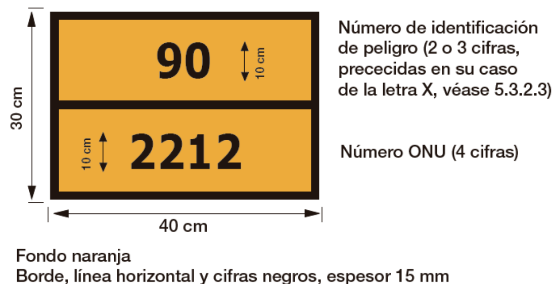
Figura 6. Señalización para unidad de transporte de mercancías peligrosas.
